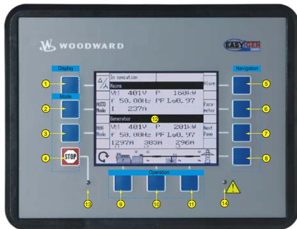
Рис. 5-2: Передняя панель и дисплей
