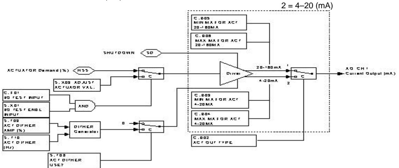
Figure 3-9. Actuator Control Logic
