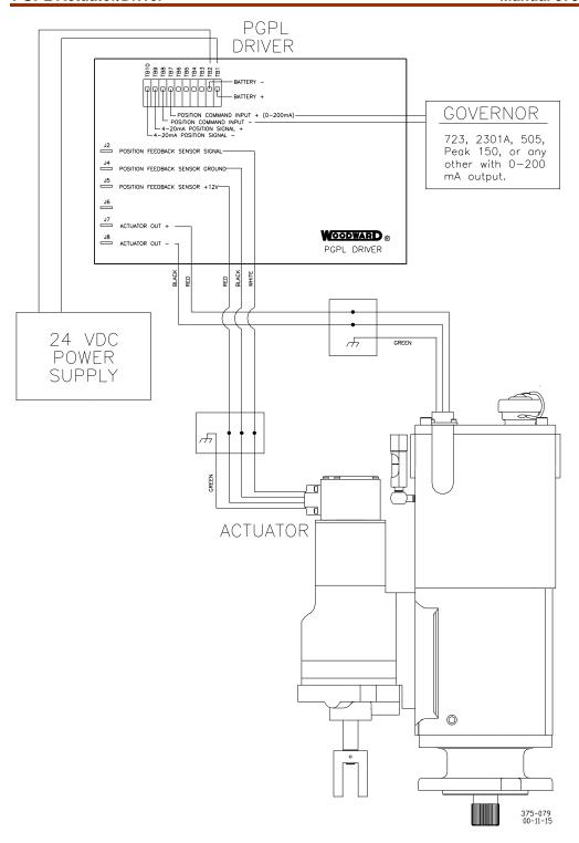
Figure 2-9. System Wiring Overview
